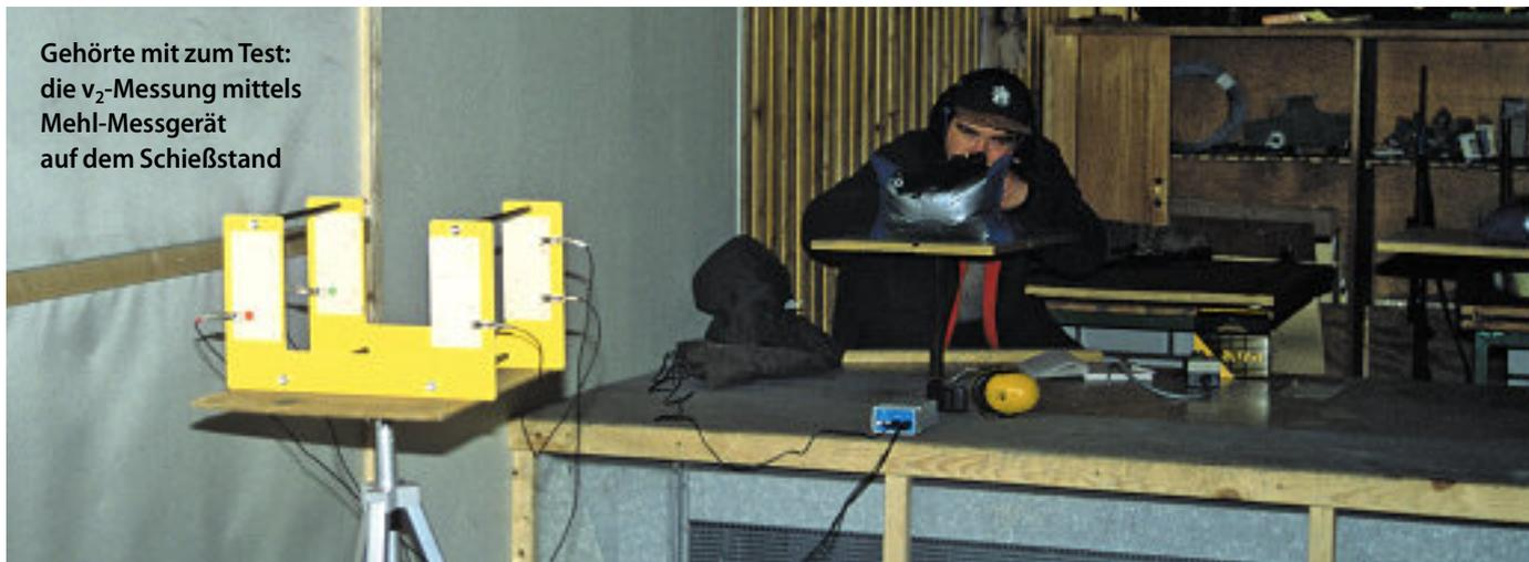
Gehörte mit zum Test: die  $v_2$ -Messung mittels Mehl-Messgerät auf dem Schießstand
